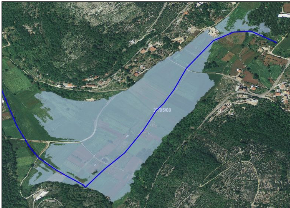
Fig. 29: ricostruzione in GIS dell'inondazione del 22-12-2019. Si è stimata un altezza idrica massima di circa 100-110 cm.
