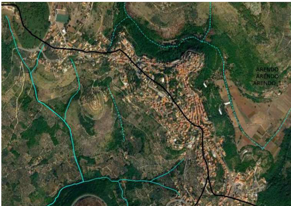
Figura – Ortofoto del centro urbano di Lenola. Sulla destra, tratteggiato in colore ciano, è il tracciato del torrente Pantano. In nero il confine del sottobacino idrografico la quale rappresenta la linea spartiacque con il sottobacino PED-200. A sinistra, in colore ciano, parte del reticolo idrografico del sottobacino PED-200
